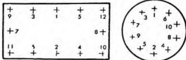
FIG. 15 et 16. — Ordre de serrage des écrous d'une bride.
