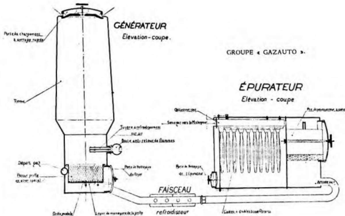
b) Filtre : il se compose d'un faisceau formé d'un nombre variable de cadres garnis de grillage métallique et revêtus de tissus filtrants. Le gaz traverse ces tissus en y abandonnant les poussières fines qu'il contenait encore.
