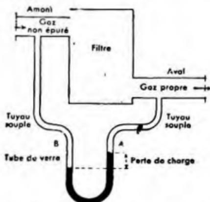
FIG. 3. — Schéma de montage pour la mesure d'une perte de charge.
