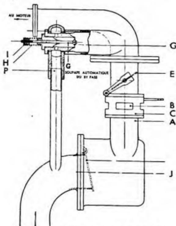
FIG. 20. — Mélangeur Renault à « by pass ».
