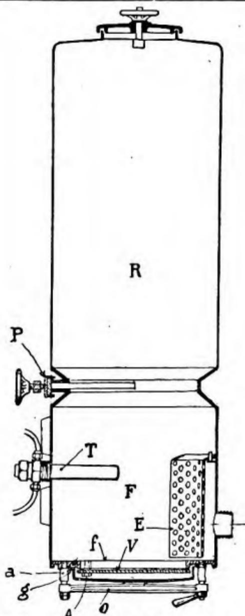
FIG. 25. — Gazogène Gohin-Poulenc. — Générateur.
