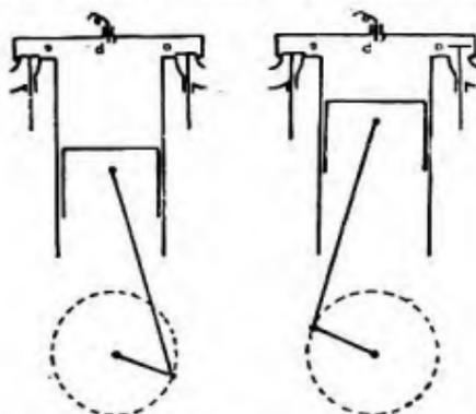
FIG. 32. — Course d'explosion-détente. FIG. 33. — Course d'échappement.
