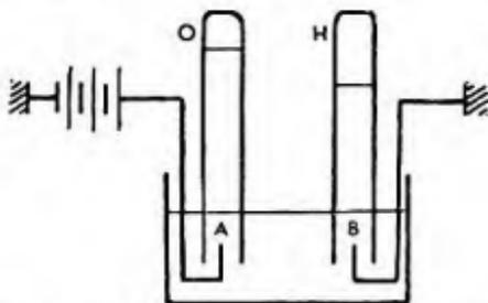
FIG. 4. — Schéma de montage pour la décomposition de l'eau.
