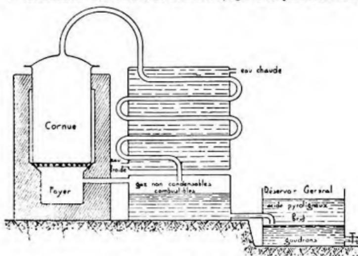
FIG. 5. — Schéma d'un appareil pour la distillation du bois.
