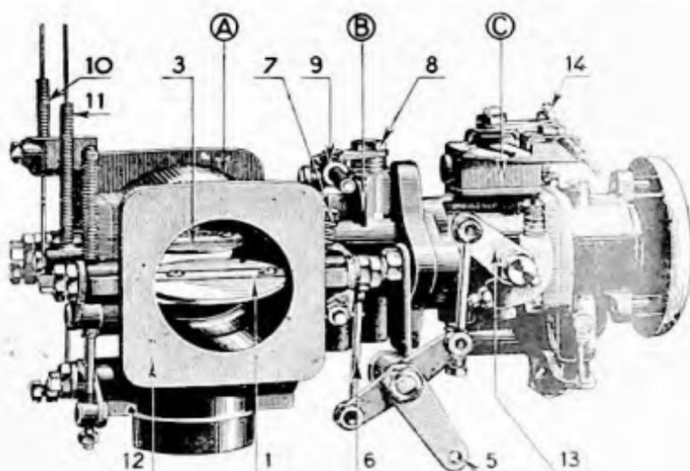
FIG. 35. — Le Carburateur-Mélangeur Solex, vu côté moteur, orienté horizontalement.
