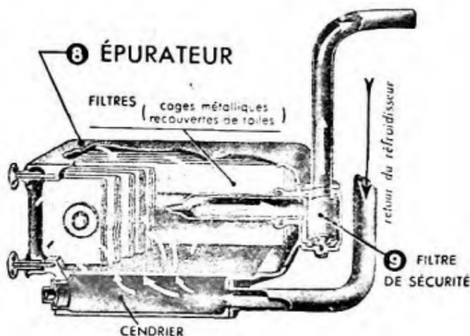
FIG. 23. — Gazogène Panhard. — Epurateur (modèle simplifié).
