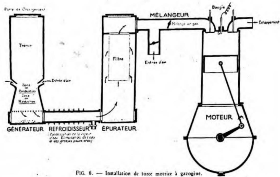
FIG. 6. — Installation de force motrice à gazogène.
