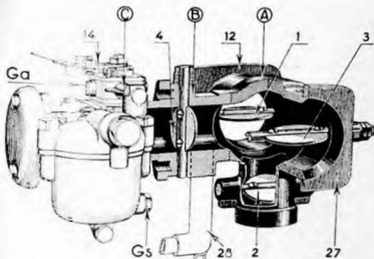
FIG. 36. — Coupe schématique du Mélangeur Solex, orienté horizontalement.
