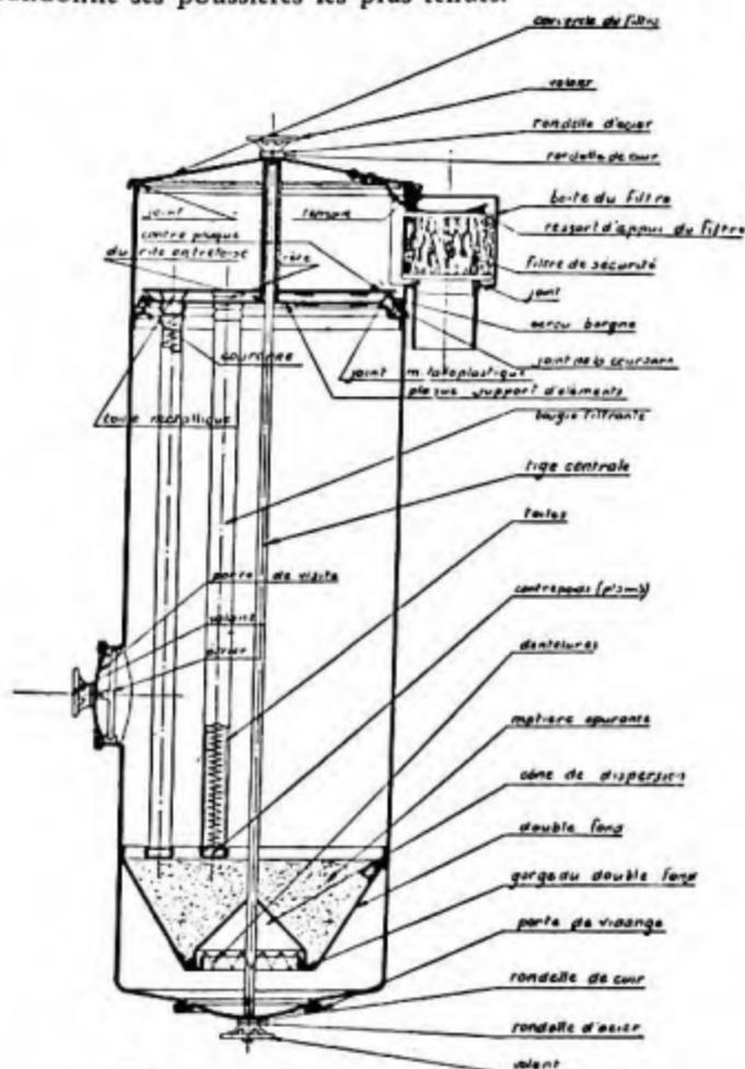
FIG. 27 bis. — Filtre à éléments tubulaires.
