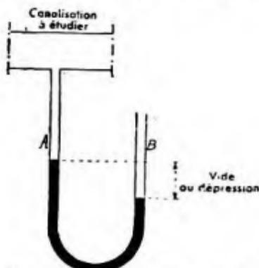
FIG. 2. — Schéma de manomètre à dépression.
