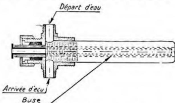
FIG. 26. — Gazogène Gohin-Poulenc. — Tuyère.
