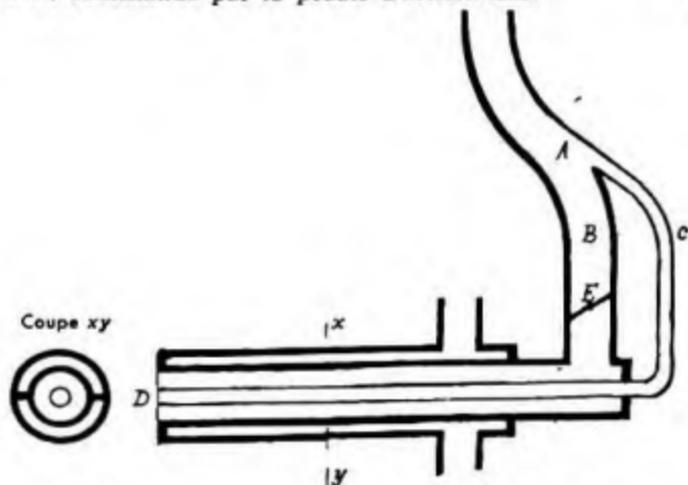
FIG. 29. — Gazogène Gohin-Poulenc. — Tuyère de ralenti.
