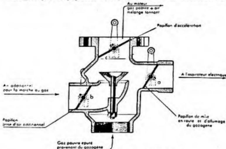
FIG. 19. — Gazogène Berliet. — Mélangeur.
